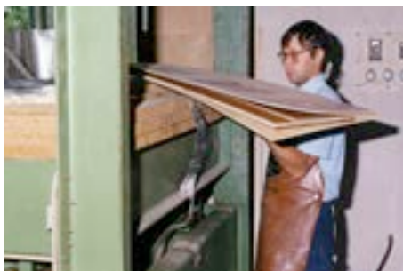
Inserimento pannelli nella pressa
